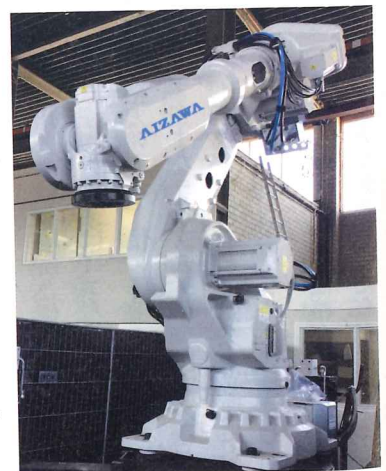
スイスABB製大型アームロボットを導入。速乾性の高い特殊コンクリート材料を建設現場で「印刷」する技術で、家やビルはプリントする時代を迎えた
